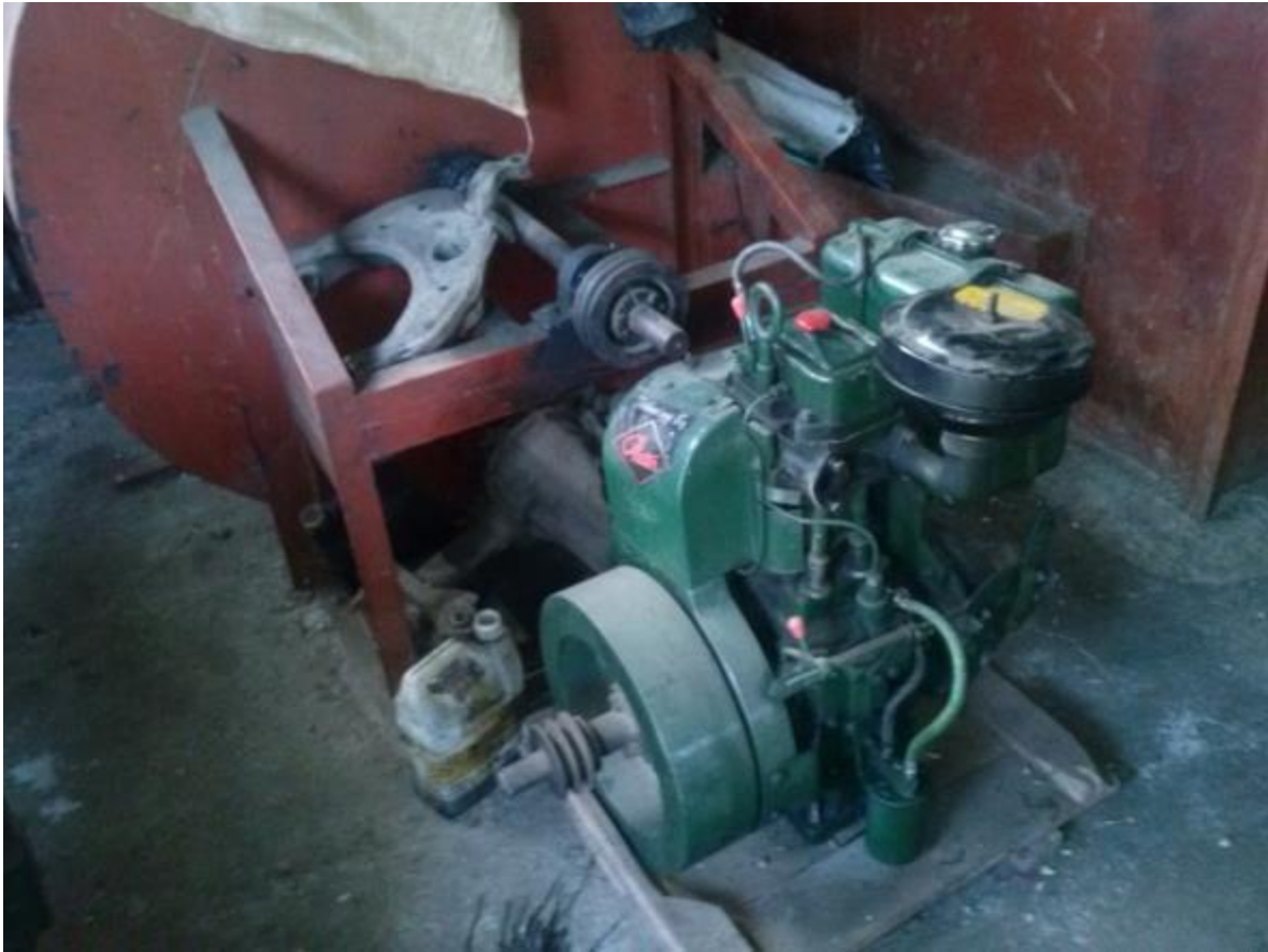
Fotografía 8 Motor de combustión interna (diesel) para el secamiento de cardamomo
