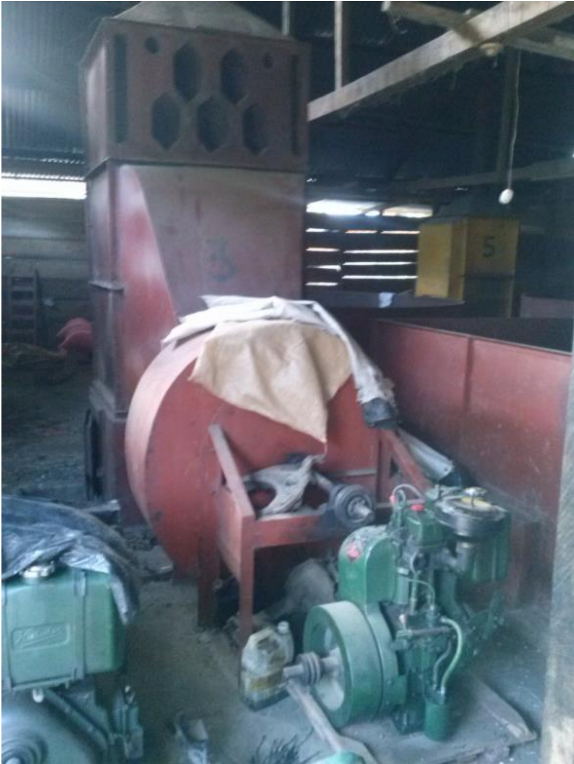
Fotografía 9 Motor, horno y pila de secadora de cardamomo con diesel
