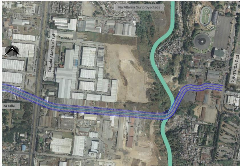
El proyecto “Conexión Vial Zona 12 – Zona 13 Ciudad de Guatemala” consiste en la conexión vial a través de un puente entre zona 12 y zona 13; dicha conexión se proyecta específicamente desde Calzada Atanasio Tzul y 24 calle zona 12 hacia 7 avenida zona 13, el mismo contempla la construcción de un puente de aproximadamente 1.1 kilómetros de longitud, en el que se desplazarán 3 carriles por cada sentido .
