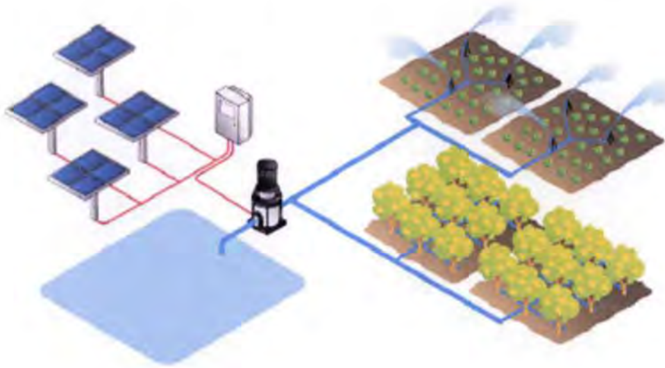
Figura 19. Configuración bombeo solar, depósito de superficie.
